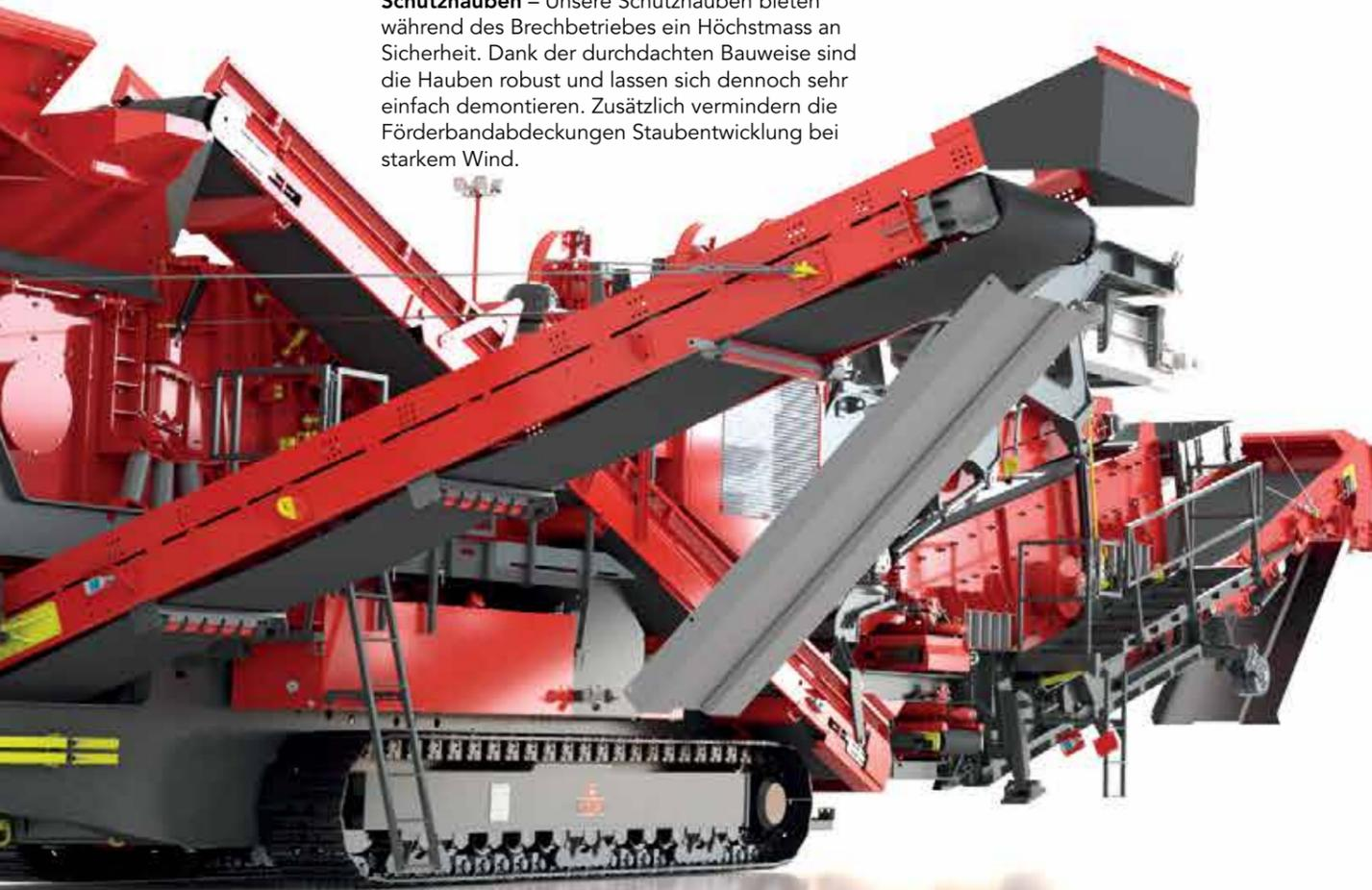
**Schwenkband** – Das Schwenkband ermöglicht einen flexiblen und vielseitigen Materialabwurf. Diese Konstruktion kann während des Arbeitsprozesses hydraulisch geschwenkt werden, um das gebrochene Material beispielsweise auf die Halde oder auf eine nachgeschaltete Siebanlage zu fördern. Ausserdem verfügt diese Anlage über einen Eisenaustrag in Längsrichtung.
