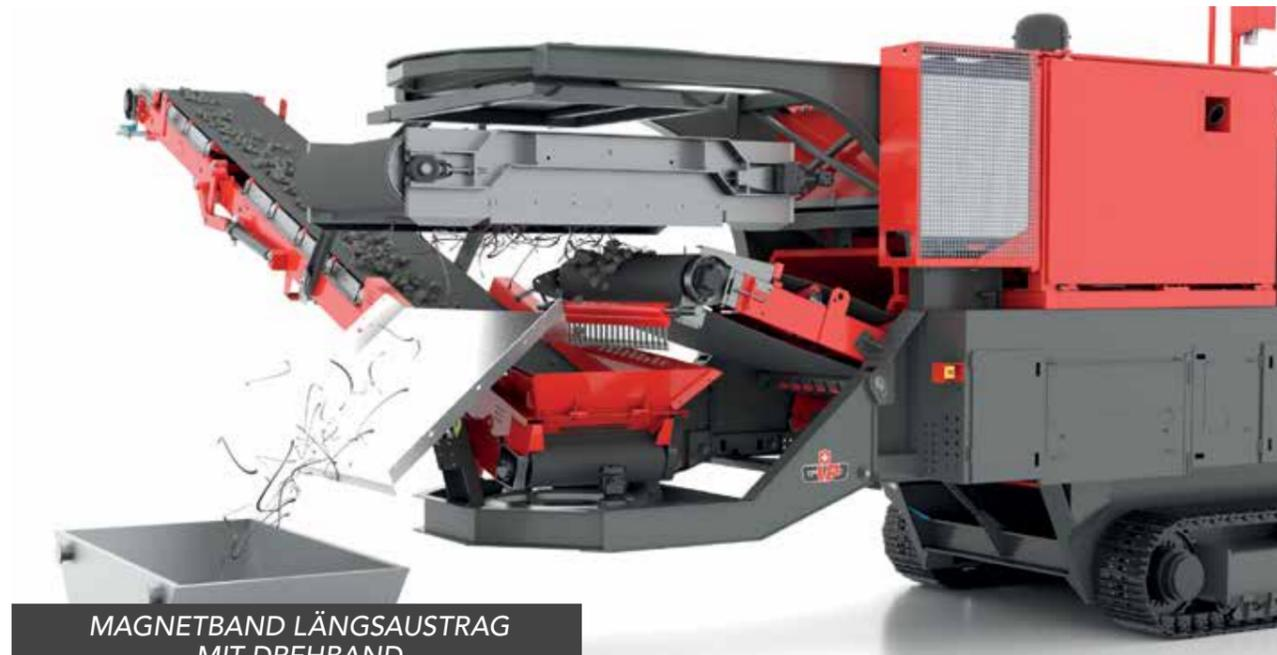
MAGNETBAND LÄNGSAUSTRAG MIT DREHBAND
