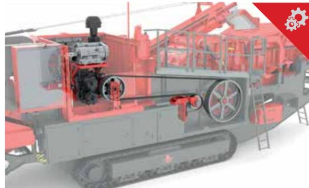
DIESEL – HYDRAULISCH MIT BRECHER IM DIREKTANTRIEB
