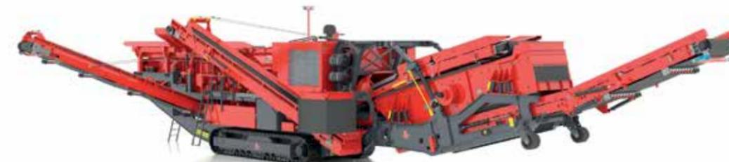
Les modèles de base de la série GIPO P GIGA, à savoir R 90 / R 100 / R 131 / R 150 / R 170, peuvent être complétés par un cribleur embarqué doté de 1 à 3 étages. Ces concasseurs à percussion perfectionnés filtrent le matériau traité pour fournir un produit final qualifié. Les modèles de base peuvent être étendus selon les souhaits, transportés et exploités avec ou sans cribleur.
