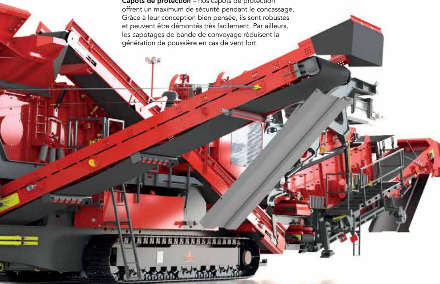
**Bande pivotante** – la bande pivotante assure une décharge de matériau flexible. Cette construction permet d'utiliser, pendant le traitement, la fonction de pivotement hydraulique de telle façon que le matériau concassé soit, par exemple, transporté sur un terril ou sur un cribleur en aval. Par ailleurs, elle effectue une décharge longitudinale de la ferraille.
