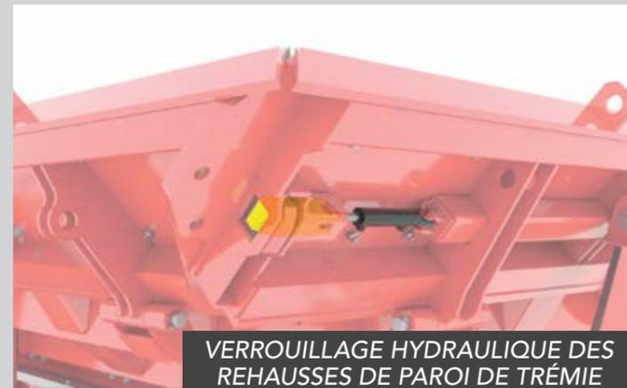
VERROUILLAGE HYDRAULIQUE DES
