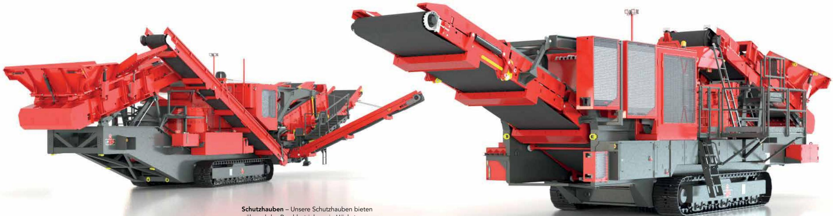
**Schutzhauben** – Unsere Schutzhauben bieten während des Brechbetriebes ein Höchstmass an Sicherheit. Dank der durchdachten Bauweise sind die Hauben robust und lassen sich dennoch sehr einfach demontieren. Zusätzlich vermindern die Förderbandabdeckungen Staubentwicklung bei starkem Wind.
