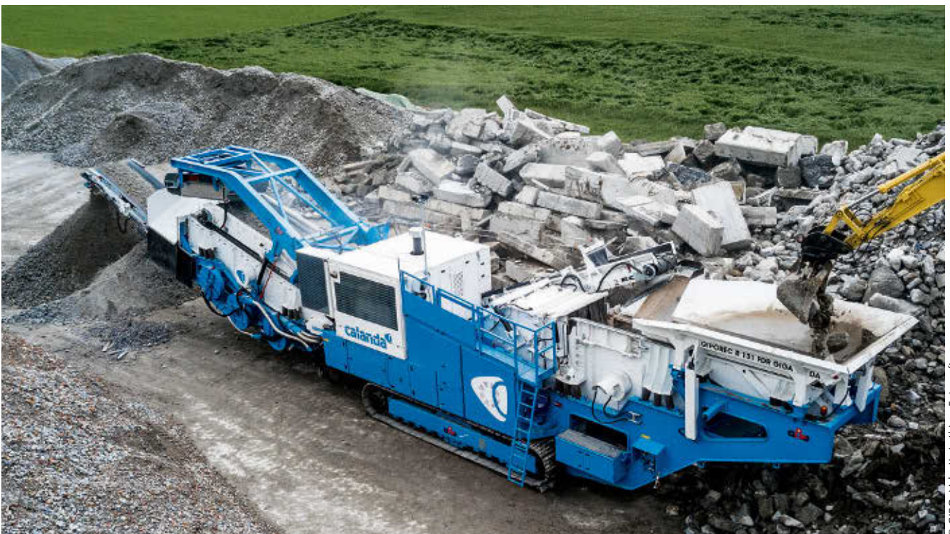
2 Die 80 t schwere Anlage wurde mit einer Vorabsiebung von 3 m Sieblänge, einem treibstoffeffizienten Dieselmotor vom Typ Scania sowie einer Zweifach-Windsichtung ausgestattet • The 80-tonne crusher is equipped with a 3-m screen for prescreening, a fuel-efficient Scania diesel engine and double air separation
