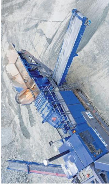
Die lange 2-Deck Vorstiebmaschine der Giporec R 130 FDR Giga DA mit einer Sieblänge von 3 m.
