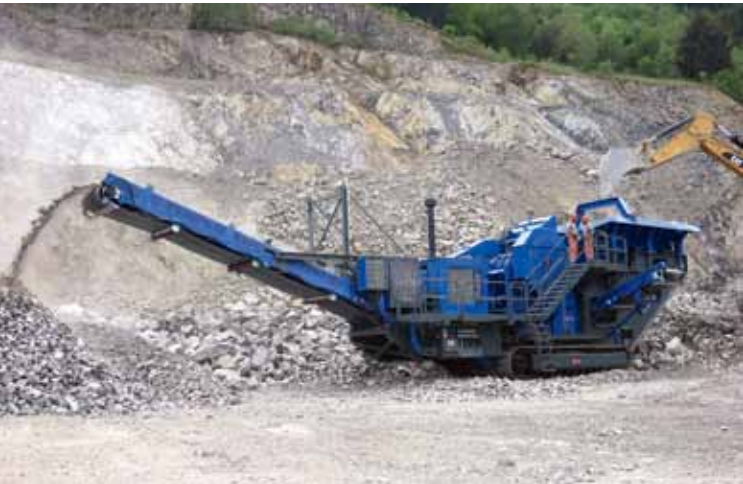
3 Raupenmobile Backenbrechanlage Typ GIPOBAC B 1410 FDR GIPOBAC B 1410 FDR track-mobile jaw crusher
