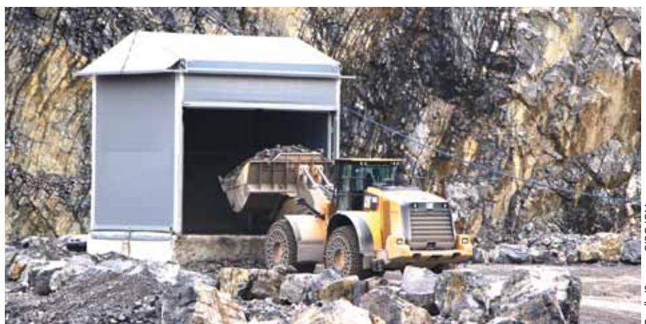
2 Das vorgebrochene Material wird kontinuierlich in einen 100 m hohen Vertikalschacht geschüttet und gelangt auf einem 912 m langen Förderbandstollen zu Produktionsanlagen für Hartsteinkomponenten im Rotzloch • The pre-crushed material is dumped into a 100-m-high vertical shaft and reaches on a 912-m-long belt conveyor the production equipment for hard rock components in Rotzloch
