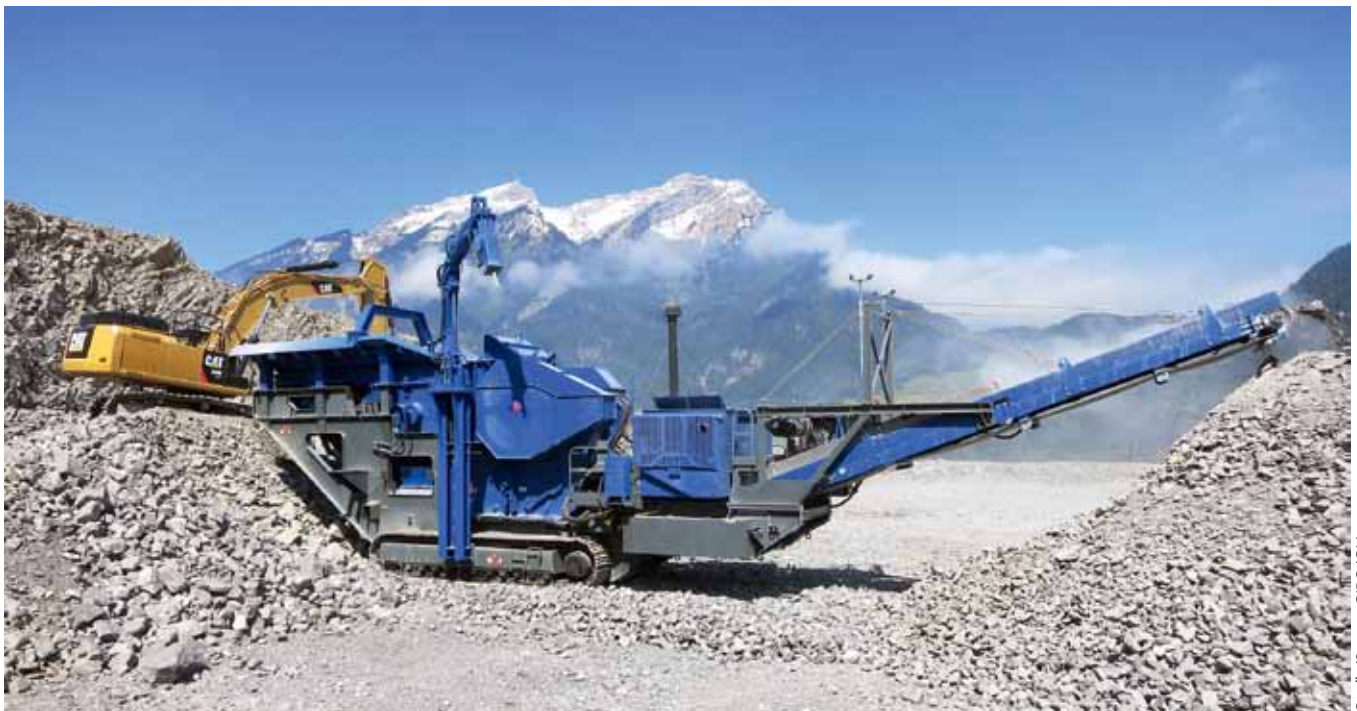
4 Brechanlage nach Kundenwunsch: tiefere Aufgabenhöhe des Trichters, Füllstandskontrolle mit automatischer Abschaltung, Verlängerung des Austragsbands, seitliche Laufstege und Podeste für die sichere Zugänglichkeit bei der Wartung sowie ein Hydraulikhammer auf dem Einlauftrichter • In this crusher, the specific requirements of the plant operator were met; lower feed height for the hopper, filling level control with automatic shut-off, lengthening of the discharge belt, walkways and platforms at the sides for safe access and maintenance as well as a hydraulic hammer at the feed hopper
