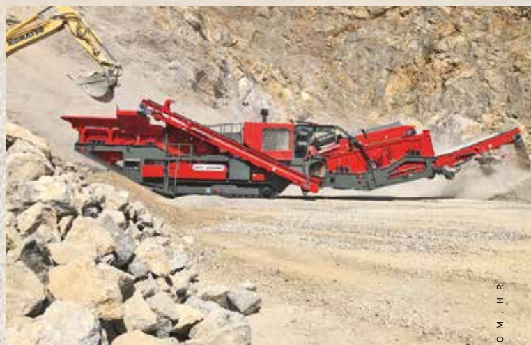
Postrojenje GIPOREC R 131 C GIGA DA - proizvodnja frakcije 0-32 u kamenolomu Barilović
