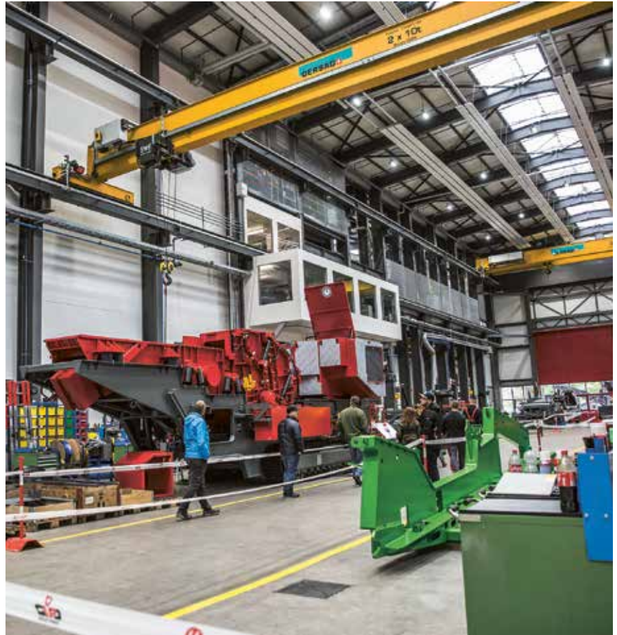
In der Endmontage werden alle vorbereiteten Komponenten präzise zusammgebaut. Dieser Schritt erfordert fundiertes Fachwissen, um sicherzustellen, dass die Einzelteile korrekt integriert werden. Zwei Wochen umfasst etwa die Endmontage einschließlich Hydraulik, abhängig von der jeweiligen Anlage. Foto: Gipo
