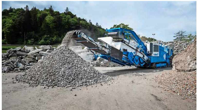
Ein Prallbrecher Giporec R 131 im Einsatz. So entstehen neue Baustoffe aus Naturstein oder Bauabfällen für die zahlreichen Baustellen
