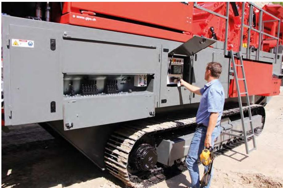
■ Die technischen Merkmale der GIPOREC 131 Giga sind der robuste und leistungsfähig konzipierte Prallbrecher P 131 mit einem Prallmühle-Einlauf von 1270 x 920 mm und die grosse Nachsiebmaschine von 1500 x 5500 mm.
